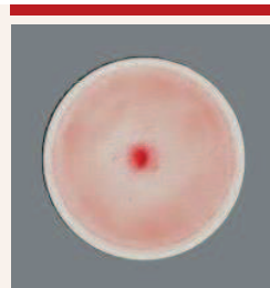
Staubfilter nach einem Heubachtest von behandeltem Saatgut ohne Film Coating
